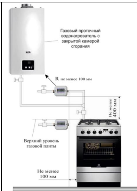
Рис. 2. Установка счётчика газа ЭКО НОМ вариант: котёл с закрытой камерой сгорания
